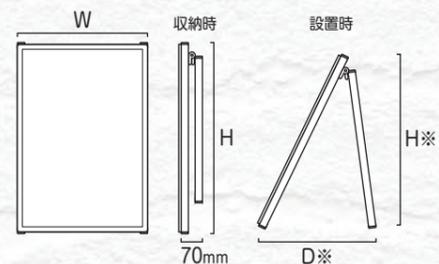
※設置時の高さ (H) と奥行 (D) は設置角度により変動します。
