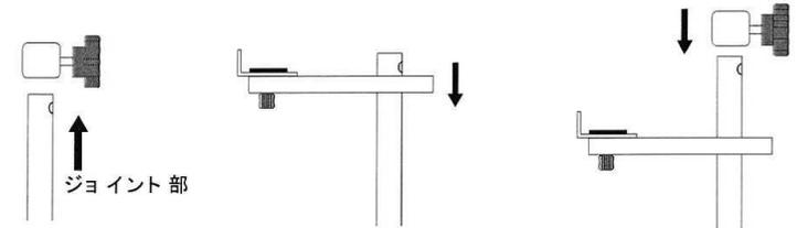
※下段ポールに受けホルダーを取り付ける際は、上記図の様に一度ポールのジョイント部を外した状態にし、
