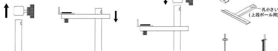
※下段ポールにホルダーを取り付ける際は、上記図の様に一度ポールのジョイント部を外した状態にし、受けホルダーを下段ポールに通した後、下段ポールに空いている穴にジョイント部をきっちり合わせ、再びジョイント部を取り付けて下さい。
