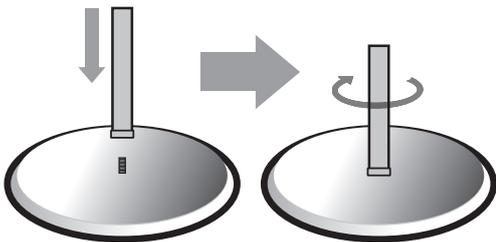
ベースのネジ部分にポールを回して固定します。
