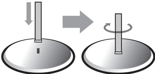
ベースのネジ部分にポールを回して固定します。
