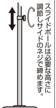
スライドポールは必要な高さに調節しサイドのネジで締めます。
