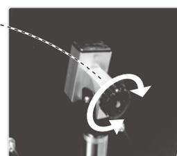
背面のネジで面板の方向を調整します。
