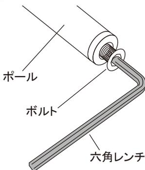
②取り外したボルトを四角ベースのネジ穴に裏側(ネジ穴の周りがかぼんでいる側)から差し込み、再びポールのネジ穴に取り付けて、付属の六角レンチで締め込んで下さい。
