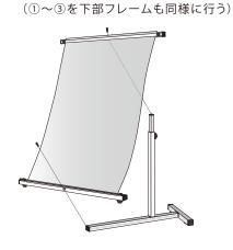
⑥上部フレーム、下部フレームともに 図のとおりにボルトで固定する
