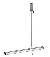
④伸縮フレームにベースフレーム(縦)を 取り付けボルトで固定する
