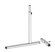
⑤ベースフレーム(縦)にベースフレーム(横)を 取り付けボルトで固定する
