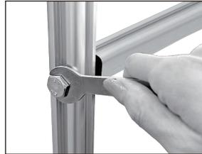
脚部と本体ポールをボルトでしっかり固定して下さい。ボルトを回す工具は付属のスパナをご使用下さい。
