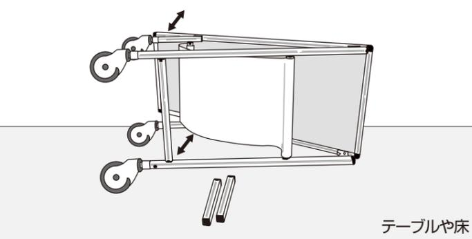
③ 横パイプ両側の黒いキャップがフレームに沿うように合わせる(突起がある側が外侧)付属のボルトで4箇所をまず、手で仮止めをした後、六角レンチで固く接続してください。
