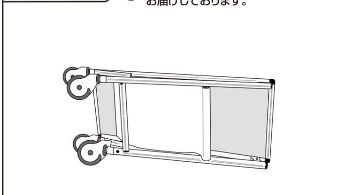
② 閉じているパネル側フレームと支えフレームを開き付属の横パイプで接続する(テーブルや床に横向きに寝かせた状態で作業する)
