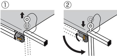
① スタンド脚部を固定しているビスを引き抜きギアを開きます。
