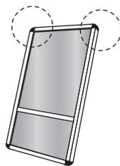
2) フレームを外した上側から、面板を引き上げてポスター(印刷物)をセットし、再び溝に合わせ差し込みます。
