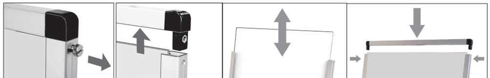
1) パネルフレーム上部の樹脂コーナーを止めている左右のビスを緩め取り外します。ビスを外したらフレームの上辺を上げ引き抜いて下さい。(ビスが固い場合はコインなどをご利用下さい。)
