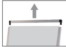
③ ネジを外した状態でフレームの下辺を引きあげ取り外します。
