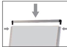
⑤ 面板セット後は下辺フレームを戻して両側をネジで固定します。
