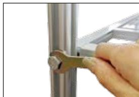
取り扱い説明書に同梱のベース部取付用ボルトで、本体パーツとベースパーツを取り付けます。手で絞め込んだ後、付属のスパナでしっかりと絞め込んで下さい。
